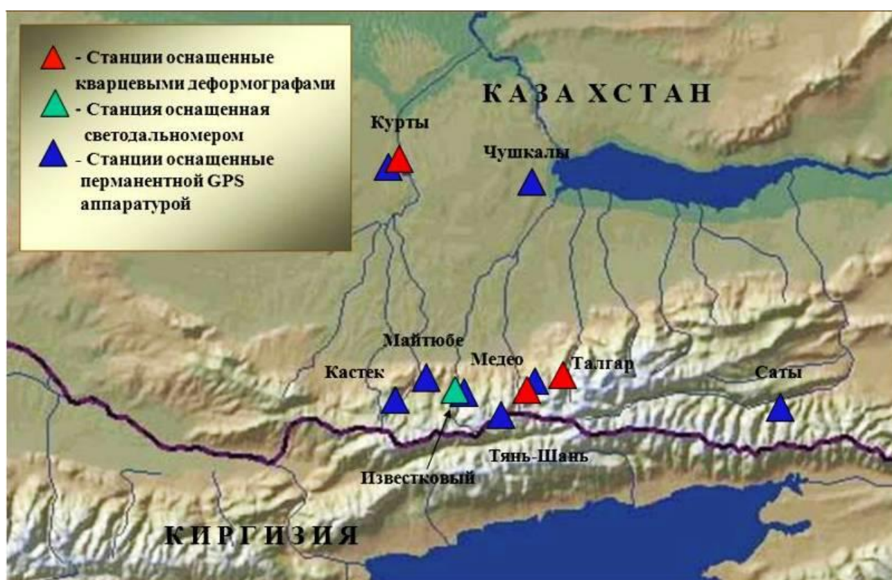
7- Сурет- Деформографтармен, наклономерлармен, светодальномерлармен және перманентті GPS қабылдағыштармен жабдықталған станциялардың орналасуларының сызбасы
